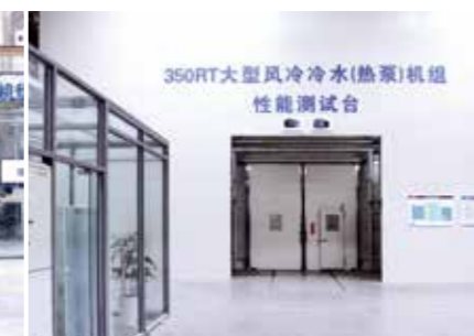
Лаборатория для проверки чиллера воздушного охлаждения до 350RT (1231кВт)
