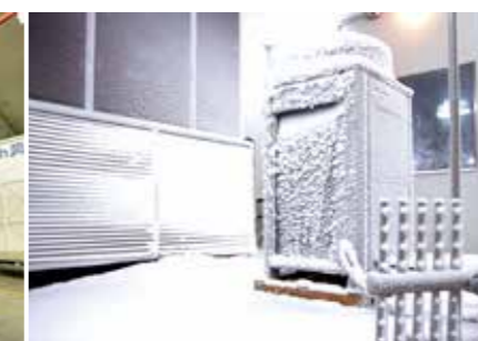
Лаборатория с симуляцией снега. Диапазон температур в лаборатории составляет -40°C~55°C
